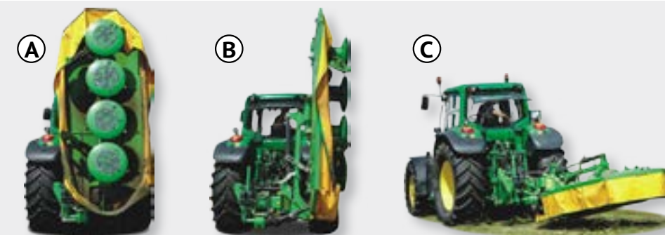
3 Transport-Stellungen: A) senkrecht hinter dem Traktor, B) senkrecht seitlich am Traktor, C) waagrecht hinter dem Traktor.
